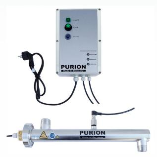
El sistema PURION 1000 es ofrecido con reactor de acero inoxidable. Es utilizado para la desinfección de agua potable y para beber con un flujo máximo de 1.000 l/h y una transmisión (transparencia de agua) mínimo de 90% por cm. Otro uso es en piscinas y estanques de peces con un máximo volumen de 10.000 l.
